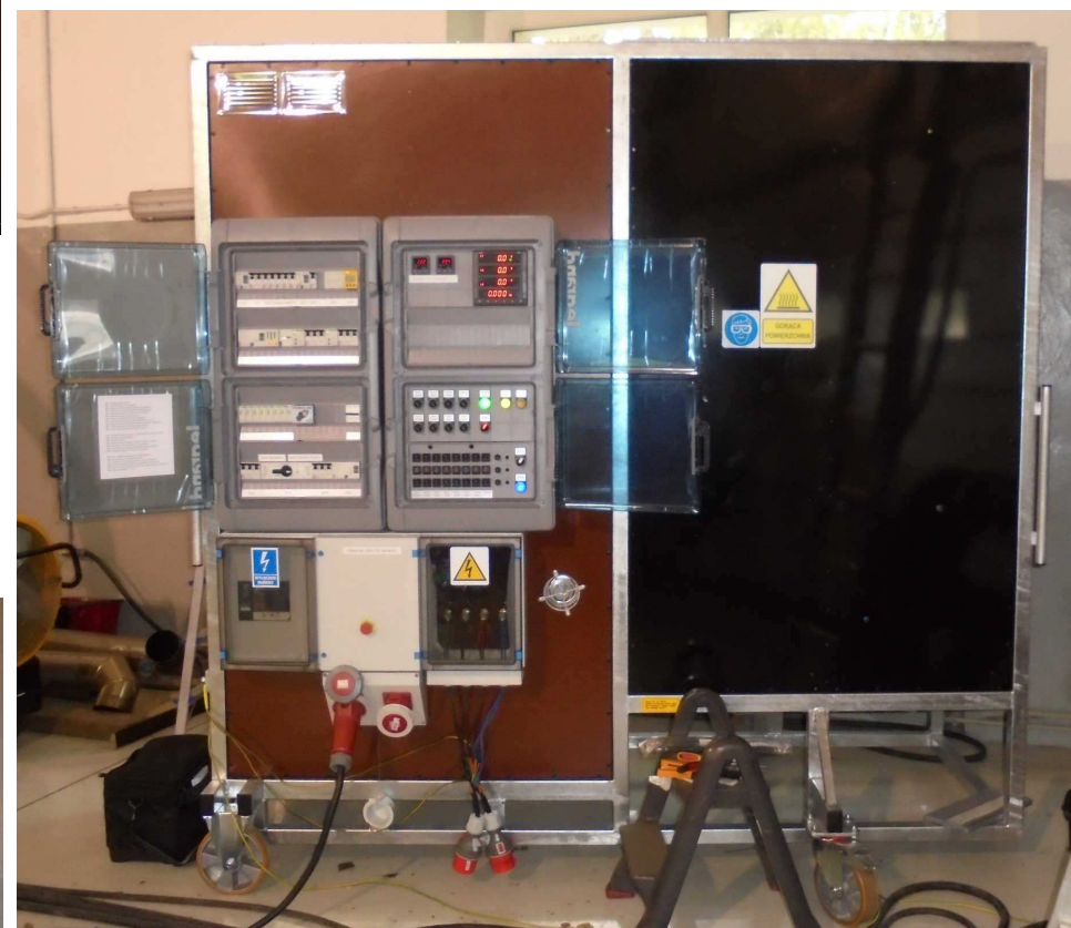
Widok na obciążnicę U_n = 3 \times 230/400\text{V}, 50\text{Hz} ; P_n = 120\text{kW}/S_n = 127\text{kVA} .
