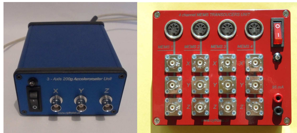
Rys. 3 Zasilacz trzykanałowy (z lewej) i dwunastokanałowy (z prawej), wyjścia napięciowe, złącza BNC Amphenol.
